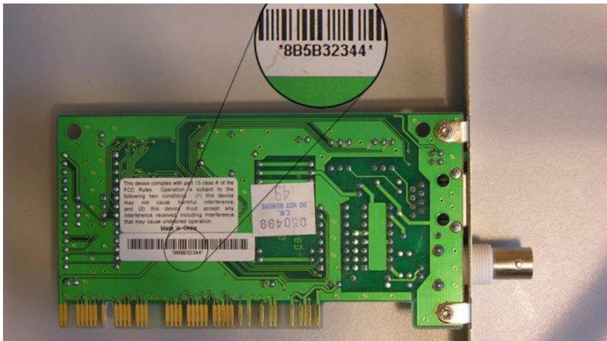
Scheda di rete con il particolare del suo specifico MAC
