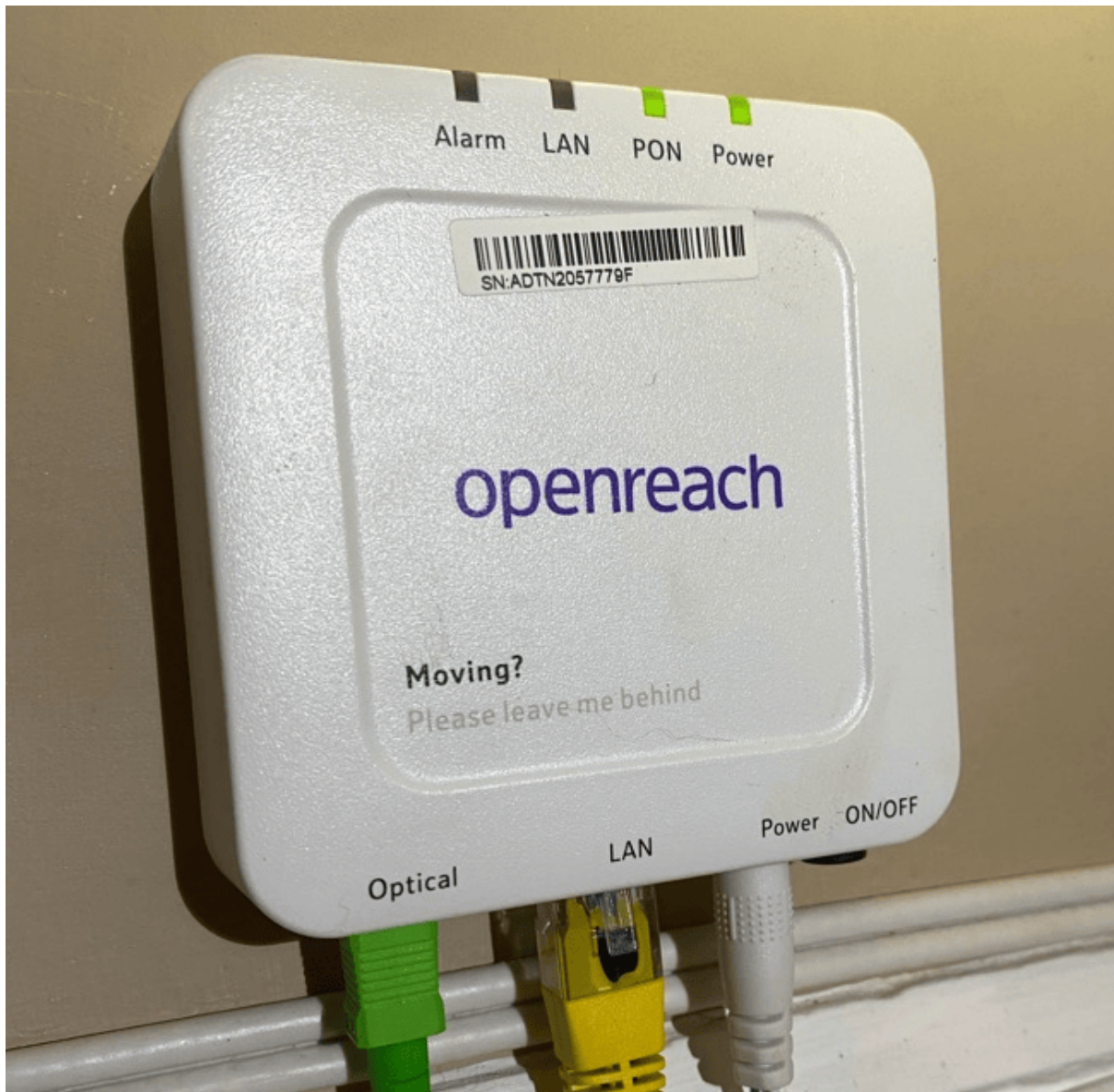
Un ONT. Notare che entra il segnale digitale, dal cavo LAN (la rete locale) ed esce un segnale ottico, dal cavo Optical
